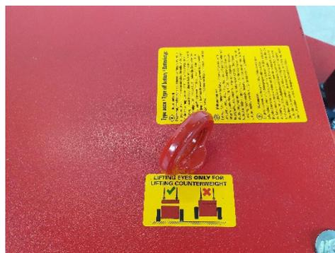
Bei diesem Modell gibt es 2 Kontergewichtschichten von je ca. 600 Kg. Diese können Sie mit 4 mitgelieferten Hebeösen von der Maschine heben. Schrauben Sie diese Hebeösen in die dafür vorgesehenen Löcher. (siehe Foto). Sie können so nur das Gewichtspaket und nicht die gesamte Maschine anheben.
