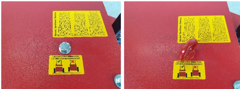
Dieses Modell kann Gegengewichtslagen von jeweils ca. 600 bis 900 kg haben. Sie können die Gegengewichte mit 4 Hebeösen von der Maschine heben. Schrauben Sie diese Hebeösen in die vorgesehenen Löcher (siehe Foto). Auf diese Weise können Sie nur das Gewichtspaket anheben und nicht die gesamte Maschine.
