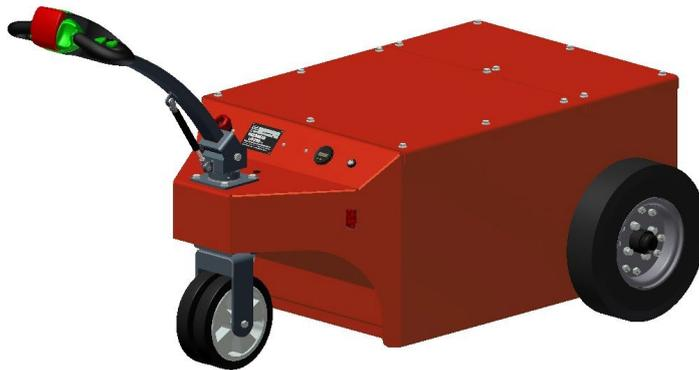
**Ziehen Sie alle Radschrauben nach den erste 2 Stunden Fahrt mit 120 nm an.**
