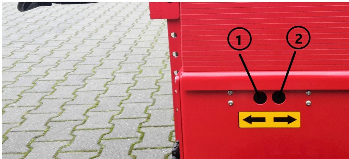
Vorne links befinden sich 2 Tasten zum langsamen Vorwärts (Fig 3, 1) - und Rückwärtsfahren (Fig 3, 2). Drücken Sie die Taste erst einmal ein, danach können Sie mit der Taste vorwärts oder rückwärts fahren. Die maximale Geschwindigkeit kann über die Potmeter (Fig 2, 7 und 8) am Deichselkopf eingestellt werden. Die maximale Entfernung, die man so fahren kann, beträgt ca. 1 Meter.
