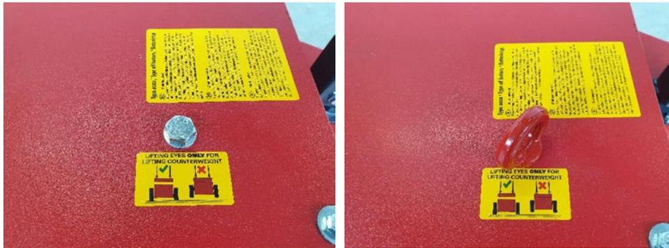
Dieses Modell hat 2 Gegengewichtslagen von je ca. 600 kg. Sie können die Gegengewichte mit 4 Hebeösen von der Maschine heben. Schrauben Sie diese Hebeösen in die vorgesehenen Löcher (siehe Foto). Auf diese Weise können Sie nur das Gewichtspaket anheben und nicht die gesamte Maschine.
