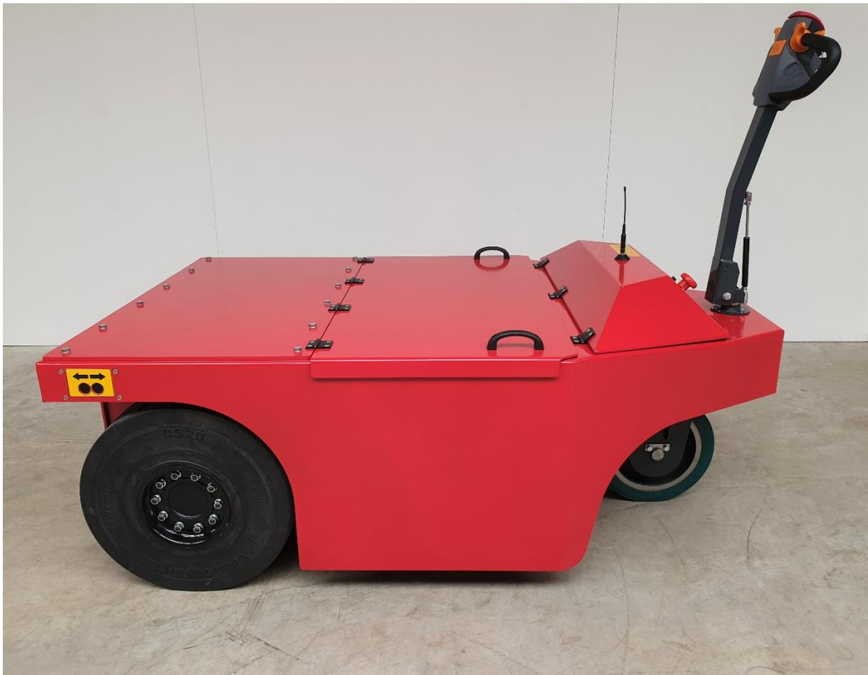
**Ziehen Sie nach den ersten zwei Fahrstunden alle Radbolzen mit 120 nm an.**
