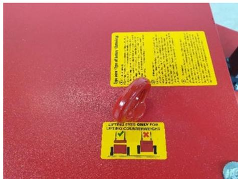
Con este modelo hay opcionalmente 1 o 2 capas de contrapeso de aprox. 600 kg cada una. Estos pueden ser levantados de la máquina con 4 cáncamos suministrados. Atornille estos ojos de elevación en los agujeros previstos. (ver foto). De esta manera sólo puedes levantar el paquete de peso y no toda la máquina.
