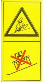
**Attention ! Risque de blessures graves par des mouvements inattendus sur les pentes à cause d'une force de traction et de freinage insuffisante du Multi-Mover XXL 20 TO.**
