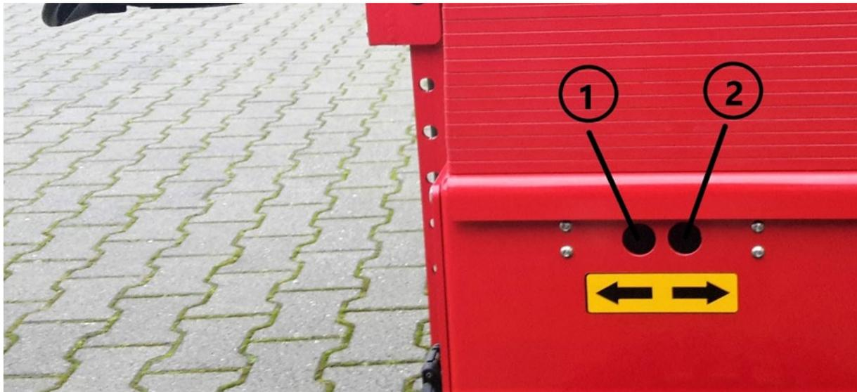
À l'avant gauche, il y a 2 boutons pour avancer (Fig 3, 1) et reculer (Fig 3, 2) lentement. Appuyez une fois sur le bouton pour le déverrouiller, et une seconde fois pour avancer ou reculer de quelques centimètres. La vitesse maximale peut être réglée à l'aide des potentiomètres (Fig 2, 7 et 8) sur la tête du timon. La distance maximale que vous pouvez parcourir de cette manière est d'environ 1 mètre.
