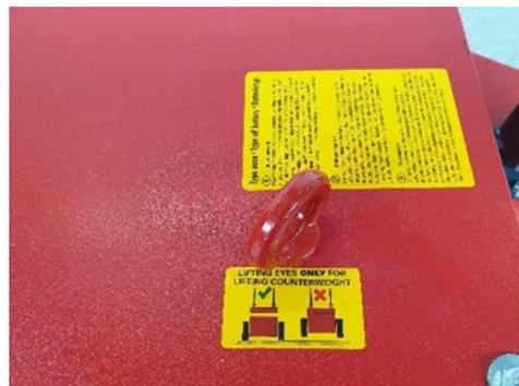
Ce modèle comporte 2 couches de contrepoids d'environ 600 kg chacune. Vous pouvez les soulever de la machine à l'aide des 4 anneaux de levage fournis. Vissez ces anneaux de levage dans les trous prévus à cet effet. (voir photo). De cette façon, vous ne pouvez soulever que le paquet de poids et non la machine entière.
