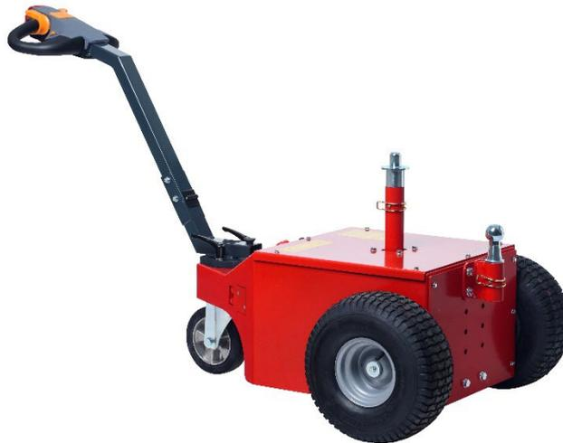
**Tutte le ruote bulloni dopo il prima 2 ore di macchina di serraggio con 25nm.**
