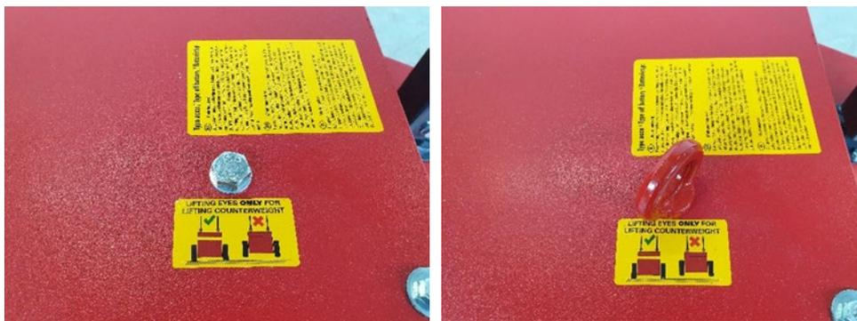
Este modelo tem duas camadas de contrapesos de aproximadamente 600Kgs cada. Pode levantá-los da máquina com os 4 olhais de elevação fornecidos. Aperte estes olhais no orifício correspondente (ver foto). Deste modo conseguirá levantar apenas os contrapesos da estrutura e não toda a máquina.
