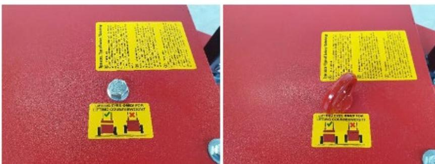
Este modelo possui 2 camadas de contrapeso de aprox. 600 kg cada. Você pode levá-los da máquina com os 4 olhais de levantamento fornecidos. Aparafuse esses olhais de levantamento nos orifícios fornecidos. (ver foto). Dessa forma, você só pode levantar o pacote de peso e não a máquina inteira.
