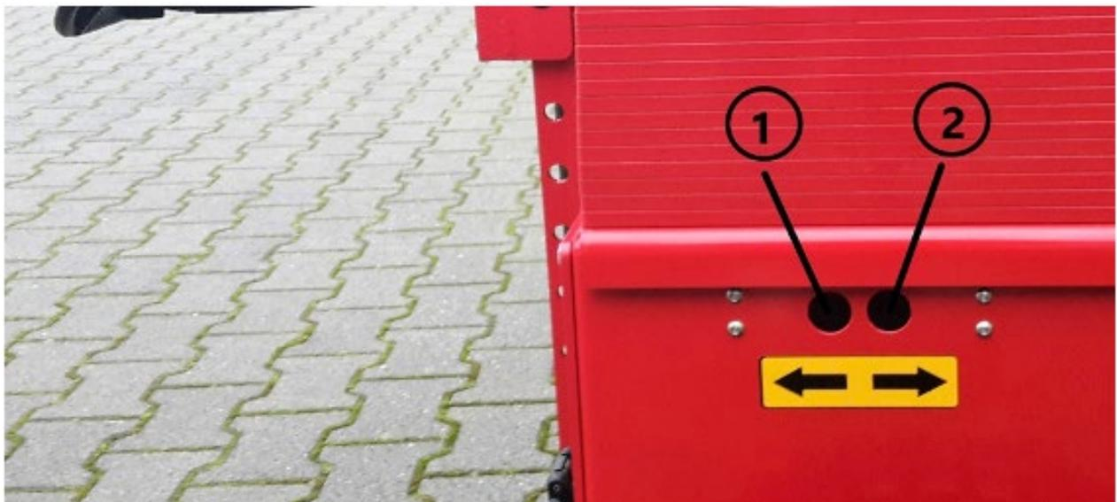
Na parte frontal esquerda, existem 2 botões para mover lentamente para a frente (Fig 3, 1) e para trás (Fig 3, 2). Pressione o botão 1 vez para destravar; pressionando o botão na segunda vez, você pode dirigir alguns centímetros para a frente ou para trás. A velocidade máxima pode ser ajustada usando os potenciômetros (Fig. 2, 7 e 8) no timão. A distância máxima que você pode viajar dessa forma é de aprox. 1 metro.
