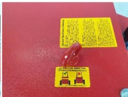
Este modelo possui 2 camadas de contrapeso de aprox. 600 kg cada. Você pode levá-los da máquina com os 4 olhais de levantamento fornecidos. Aparafuse esses olhais de levantamento nos orifícios fornecidos. (ver foto). Dessa forma, você só pode levantar o pacote de peso e não a máquina inteira.
