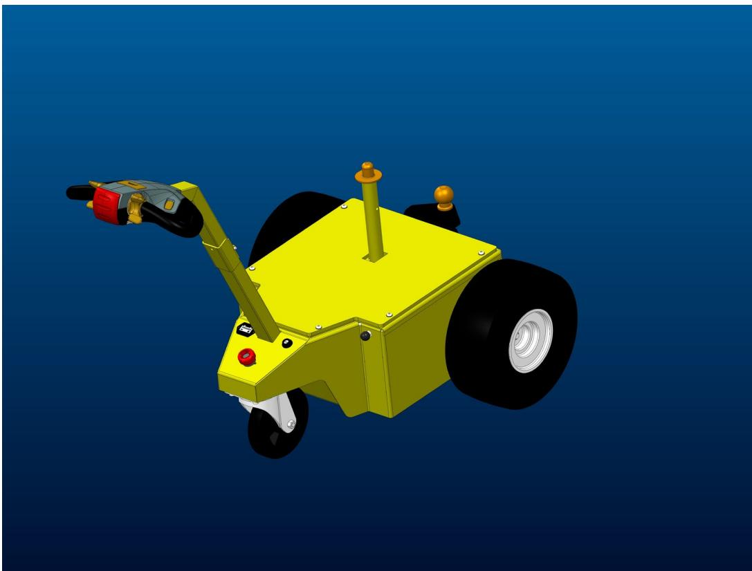
**Po prvých 2 hodinách jazdy dotiahnite všetky skrutky kolies na utáhovací moment 120 nm.**
