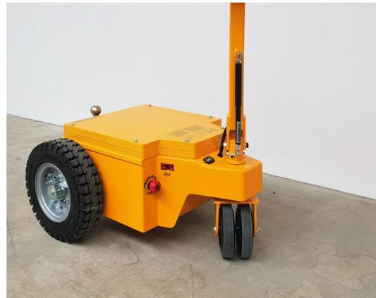
Po prvých 2 hodinách jazdy dotiahnite všetky skrutky kolies na ťahovací moment 120 nm.
