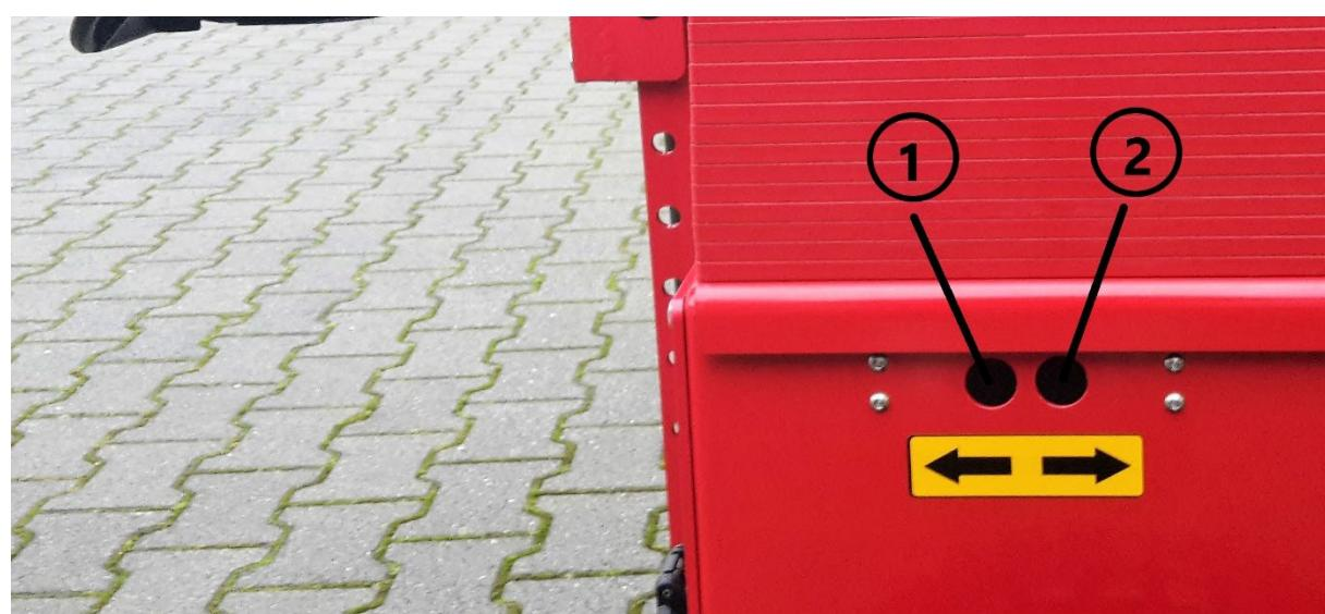
Vpredu vľavo sú 2 tlačidlá pre pomalý pohyb dopredu (obr. 3, 1) a dozadu (obr. 3, 2). Najprv stlačte tlačidlo a potom sa môžete pohybovať dopredu alebo dozadu pomocou tlačidla. Maximálnu rýchlosť je možné nastaviť pomocou hrncov (obr. 2, 7 a 8) na hlave oja. Maximálna vzdialenosť, ktorú môžete týmto spôsobom riadiť, je asi 1 meter.
